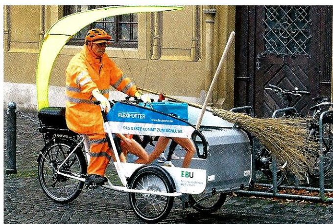
Das Bike mit optionalem Dach dient dem Schutz vor Sonne und Regen.
